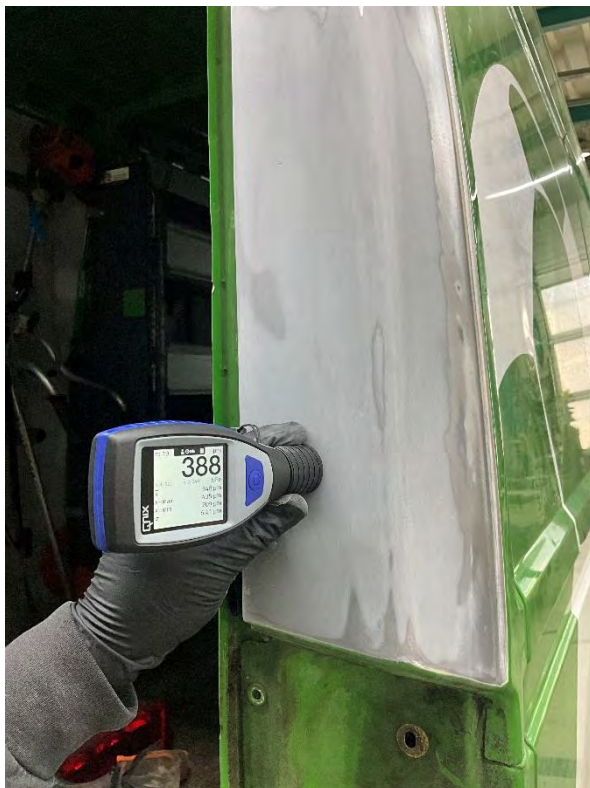
Abbildung 3: Schichtdickenmessung nach Auftrag von Karosseriefüllmasse / Schwemmsinnersatzmaterial [MRM fair claim GmbH]
